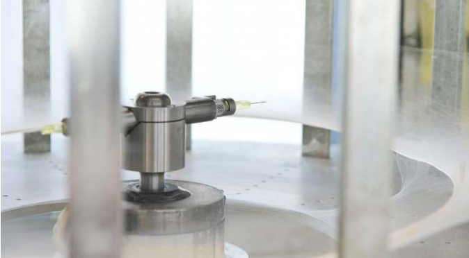
Forcespinning spinneret (Pardam)
